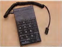
El teclado auxiliar facilita la edición de programas y el control del procesamiento de textos.
